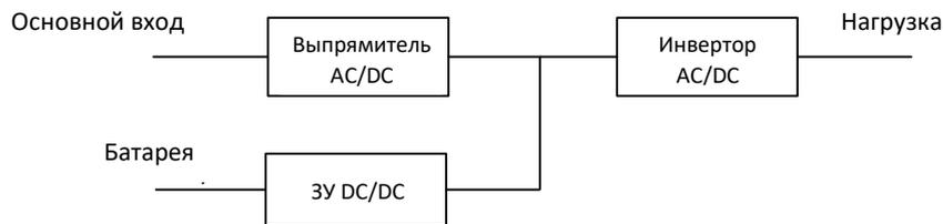
Рисунок **Ошибка! Текст указанного стиля в документе отсутствует.**-3 Структурная схема силового модуля
