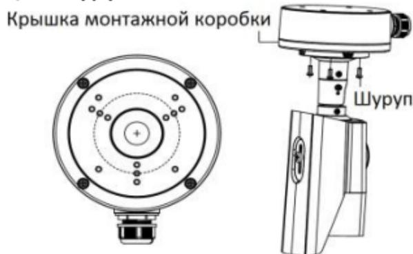
Рисунок 2-4 Установка камеры с монтажной коробкой
