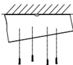
Рисунок 2-13 Установка наклонного основания
