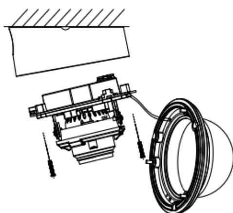
Рисунок 2-14 Закрепление камеры на основании
