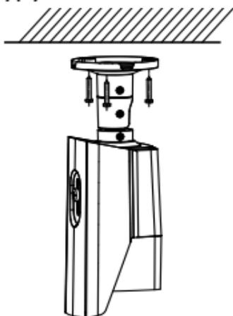
Рисунок 2-2 Установка камеры на потолке
