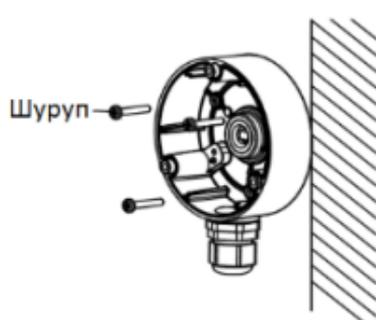
Рисунок 2-5 Установка монтажной коробки
