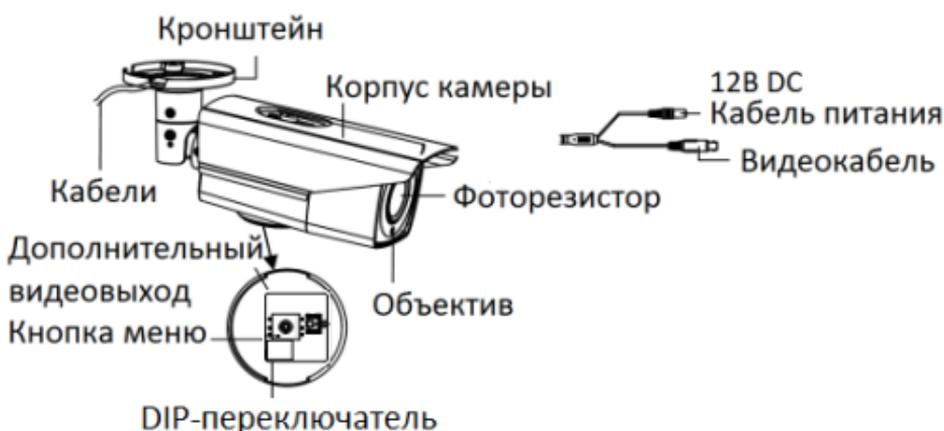
Рисунок 1-1 Камера I типа
