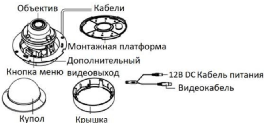
Рисунок 1-2 Камера II типа
